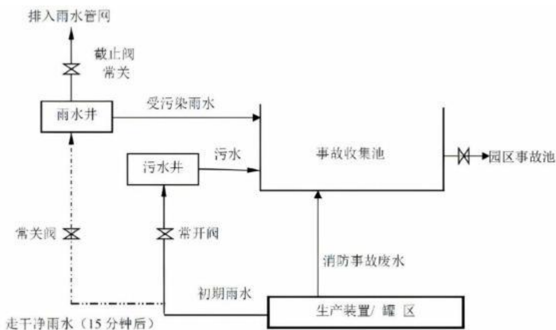
图7.6-2事故废水控制封堵系统图
